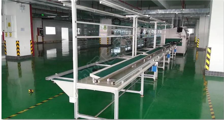
配套定制化自动化插件线/链板线
